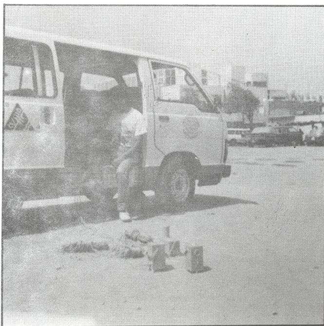
FOTOGRAFIA Nº 4: MEDICION DEL PERIODO DEL SUELO EN LA AV. COLONIAL. AL FONDO LA CERVECERIA PILSEN CALLAO. T_s = 0.16 \text{ seg.}
