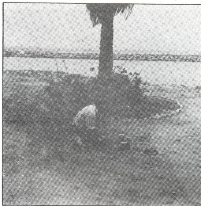
FOTOGRAFIA N° 2: MEDICION DEL PERIODO DEL SUELO AL SUR DE LA PUNTA. AL FONDO SE OBSERVA UN ESPIGON DE DEFENSA. T_s = 0.52 \text{ seg.}
