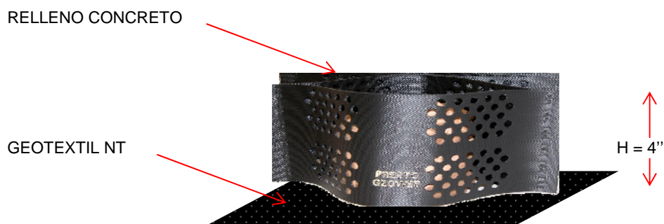
Figura 2. Sistema de Confinamiento Geocelular Perforado ( 19% - 28% )
