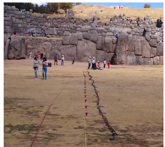
Fotografía N°06: Vista del ensayo de MASW
