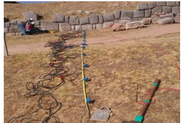
Fotografía N°05: Vista del ensayo de Refracción Sísmica
